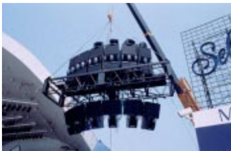
Select Live Under the Sky '87&'88は木下のプランニングによって我が国はじめての野外フライングとなった。片側8tonのスピーカーとアンプをクレーンで吊り下げた。
